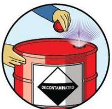
13: Etikettieren Sie das Fass als „Dekontaminiertes Fass“
